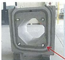
供試体の断面 高弾性接着剤 (T Bポンド)
