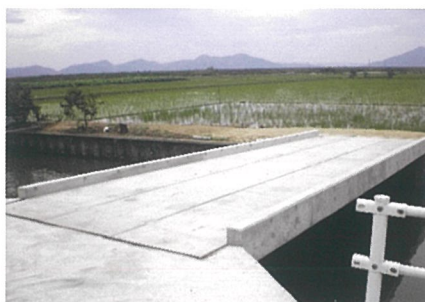
■ 標準版／地覆筋付 T-8 床版長 11,000mm 版厚 280mm
