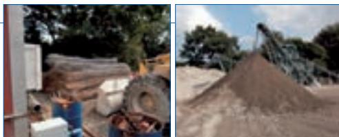
鉄筋くずはスクラップとして売却、コンクリートくずは道路の路盤材（将来的には再生骨材）へ再生利用されます
