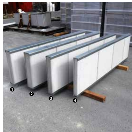
① t111両面 ② t111片面 ③ t81片面 ④ t61片面
