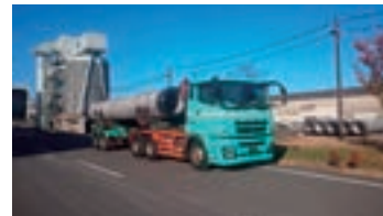
パイル出荷風景 工場から施工現場までこのようにトレーラーに固定されて運ばれます。
