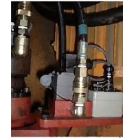
■油流量計 油流量を計測します。
