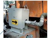
■流量計 水やセメントミルクの流量を計測します。
