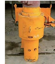
■油圧スイベル 油圧経路をオーガ内部に取り込む装置です。
