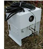
■油圧ポンプ 高圧で油を送り拡大ビットを開閉します。
