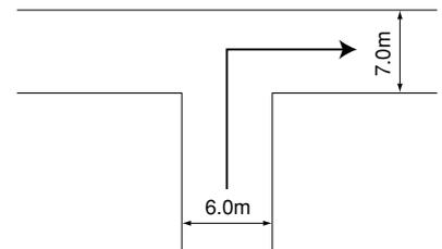
連結時走行旋回軌跡図 (mm)
