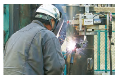
コントローラー操作による溶接 手元のコントローラーで、位置や速度を調節しながら自動で溶接。水平に回りながら溶接します。
