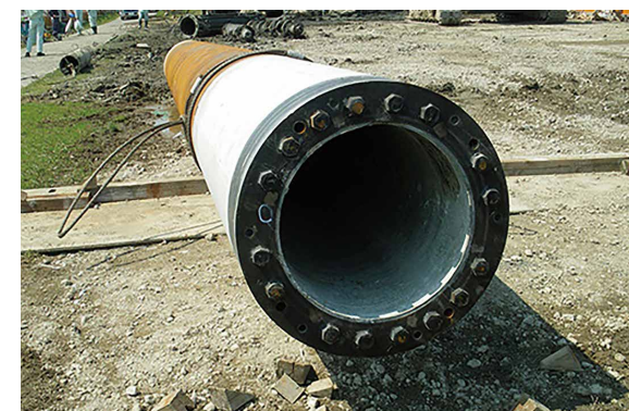
RSCP 杭（パイル）
