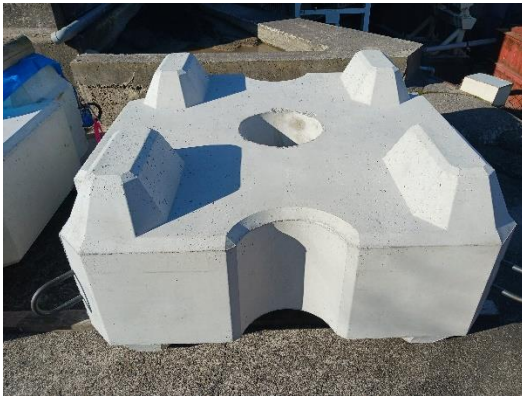
製造した根固めブロック（左写真）と姉川河床に設置した状況（右写真赤枠内）
