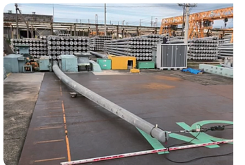
ポール曲げ性能を確認する試験を定期的の実施
