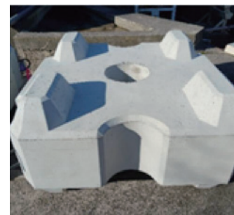
カルカーボを配合した根固めブロックと滋賀県姉川への設置状況
