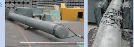
曲げ強度試験(破壊時)
