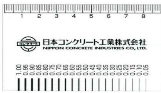
ひび割れ測定部
